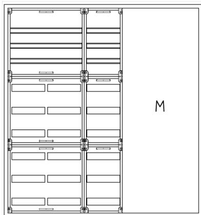
UVK5-9-210-M2-PAutomatenverteiler, UVK, BxHxT = 1300x1400x210 Schutzklasse II, IP41, RAL 9016, Unterputz
