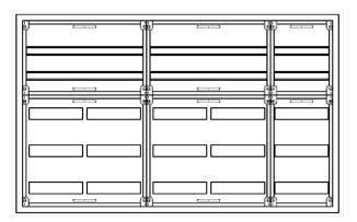
UVK5-5-210-S-PAutomatenverteiler, UVK, BxHxT = 1300x800x210Schutzklasse II, IP41, RAL 9016, UnterputzBestehend aus:Gehäuse, Doppeltür mit Drehriegel, Flansche NF1 (oben) und NF2 (unten), 2x Geräteträger 2-Feld breit 2/3 mit Feldabdeckungen PS, 1x Geräteträger 1-Feld breit 2/3 mit Feldabdeckungen PS
