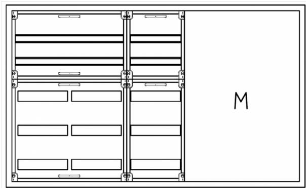
UVK5-5-210-M2 Automatenverteiler, UVK, BxHxT = 1300x800x210 Schutzklasse II, IP41, RAL 9016, Unterputz
