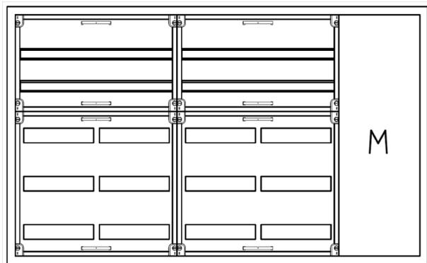
UVK5-5-210-M1-PAutomatenverteiler, UVK, BxHxT = 1300x800x210Schutzklasse II, IP41, RAL 9016, UnterputzBestehend aus:Gehäuse, Doppeltür mit Drehriegel, Flansche NF1 (oben) und NF2 (unten), 2x Geräteträger 2-Feld breit 2/3 mit Feldabdeckungen PS, 1x Montageplatte 1-Feld breit
