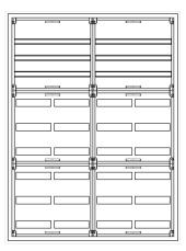
UVK4-9-210Automatenverteiler, UVK, BxHxT = 1050x1400x210Schutzklasse II, IP41, RAL 9016, UnterputzBestehend aus:Gehäuse, Doppeltür mit Drehriegel, Flansche NF1 (oben) und NF2 (unten), 2x Geräteträger 2-Feld breit 3/6 mit Feldabdeckungen PRL
