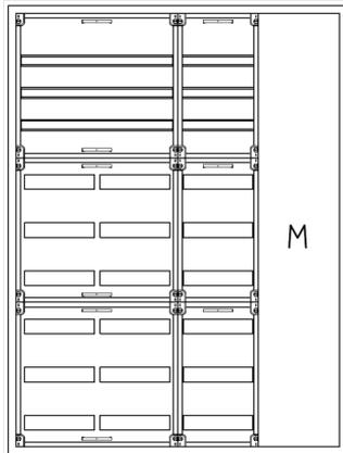
UVK4-9-210-M1-PAutomatenverteiler, UVK, BxHxT = 1050x1400x210Schutzklasse II, IP41, RAL 9016, UnterputzBestehend aus:Gehäuse, Doppeltür mit Drehriegel, Flansche NF1 (oben) und NF2 (unten), 1x Geräteträger 2-Feld breit 3/6 mit Feldabdeckungen PS, 1x Geräteträger 1-Feld breit 3/6 mit Feldabdeckungen PS, 1x Montageplatte 1-Feld breit
