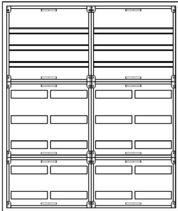
UVK4-8-210-PAutomatenverteiler, UVK, BxHxT = 1050x1250x210 Schutzklasse II, IP41, RAL 9016, Unterputz Bestehend aus: Gehäuse, Doppeltür mit Drehriegel, Flansche NF1 (oben) und NF2 (unten), 2x Geräteträger 2-Feld breit 3/5 mit Feldabdeckungen PS
