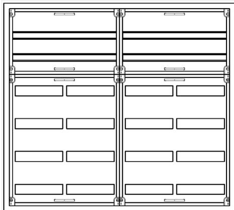
UVK4-6-210-PAutomatenverteiler, UVK, BxHxT = 1050x950x210Schutzklasse II, IP41, RAL 9016, UnterputzBestehend aus:Gehäuse, Doppeltür mit Drehriegel, Flansche NF1 (oben) und NF2 (unten), 2x Geräteträger 2-Feld breit 2/4 mit Feldabdeckungen PS
