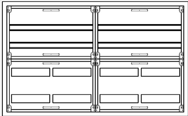
UVK4-4-210 Automatenverteiler, UVK, BxHxT = 1050x650x210 Schutzklasse II, IP41, RAL 9016, Unterputz
