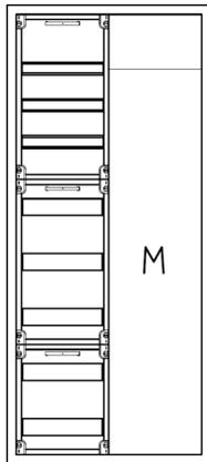
UVK2-8-210-M1-PAutomatenverteiler, UVK, BxHxT = 550x1250x210 Schutzklasse II, IP41, RAL 9016, Unterputz
