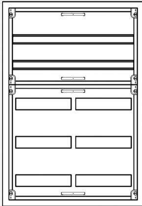
UVK2-5-210 Automatenverteiler, UVK, BxHxT = 550x800x210 Schutzklasse II, IP41, RAL 9016, Unterputz
