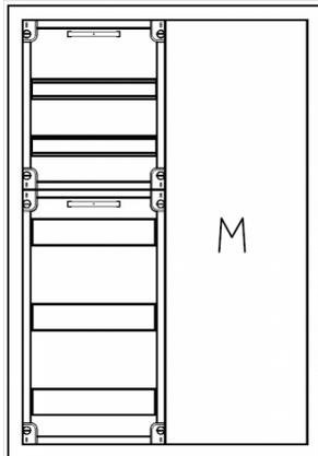
UVK2-5-210-M1 Automatenverteiler, UVK, BxHxT = 550x800x210 Schutzklasse II, IP41, RAL 9016, Unterputz
