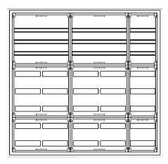
UVB5-8-210-SAutomatenverteiler, UVB, BxHxT = 1300x1250x210Schutzklasse I, IP41, RAL 9016, UnterputzBestehend aus:Gehäuse, Doppeltür mit Drehriegel, Flansche NF1 (oben) und NF2 (unten), 2x Geräteträger 2-Feld breit 3/5 mit Feldabdeckungen PRL, 1x Geräteträger 1-Feld breit 3/5 mit Feldabdeckungen PRL
