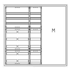
UVB5-8-210-M2-PAutomatenverteiler, UVB, BxHxT = 1300x1250x210Schutzklasse I, IP41, RAL 9016, UnterputzBestehend aus:Gehäuse, Doppeltür mit Drehriegel, Flansche NF1 (oben) und NF2 (unten), 1x Geräteträger 2-Feld breit 3/5 mit Feldabdeckungen PS, 1x Geräteträger 1-Feld breit 3/5 mit Feldabdeckungen PS, 1x Montageplatte 2-Feld breit
