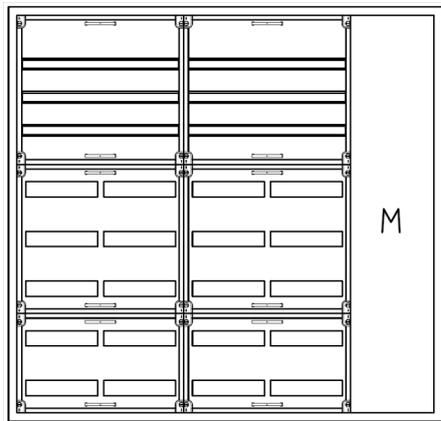
UVB5-8-210-M1-PAutomatenverteiler, UVB, BxHxT = 1300x1250x210 Schutzklasse I, IP41, RAL 9016, Unterputz
