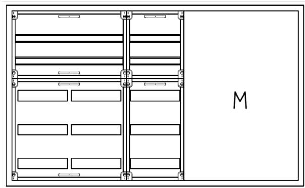
UVB5-5-210-M2 Automatenverteiler, UVB, BxHxT = 1300x800x210 Schutzklasse I, IP41, RAL 9016, Unterputz
