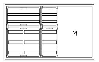
UVB5-5-210-M2-PAutomatenverteiler, UVB, BxHxT = 1300x800x210Schutzklasse I, IP41, RAL 9016, UnterputzBestehend aus:Gehäuse, Doppeltür mit Drehriegel, Flansche NF1 (oben) und NF2 (unten), 1x Geräteträger 2-Feld breit 2/3 mit Feldabdeckungen PS, 1x Geräteträger 1-Feld breit 2/3 mit Feldabdeckungen PS, 1x Montageplatte 2-Feld breit
