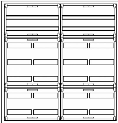
UVB4-7-210 Automatenverteiler, UVB, BxHxT = 1050x1100x210 Schutzklasse I, IP41, RAL 9016, Unterputz
