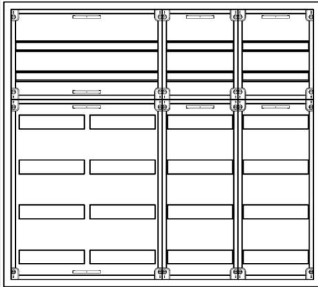
UVB4-6-210-S Automatenverteiler, UVB, BxHxT = 1050x950x210 Schutzklasse I, IP41, RAL 9016, Unterputz
