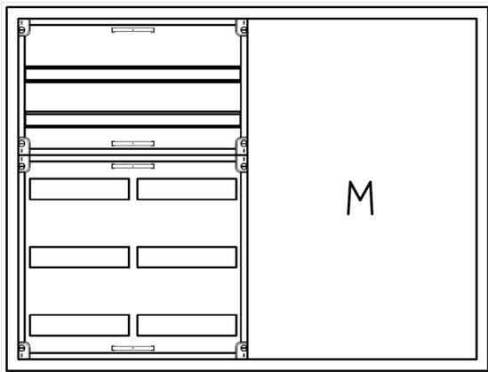
UVB4-5-210-M2-PAutomatenverteiler, UVB, BxHxT = 1050x800x210Schutzklasse I, IP41, RAL 9016, UnterputzBestehend aus:Gehäuse, Doppeltür mit Drehriegel, Flansche NF1 (oben) und NF2 (unten), 1x Geräteträger 2-Feld breit 2/3 mit Feldabdeckungen PS, 1x Montageplatte 2-Feld breit
