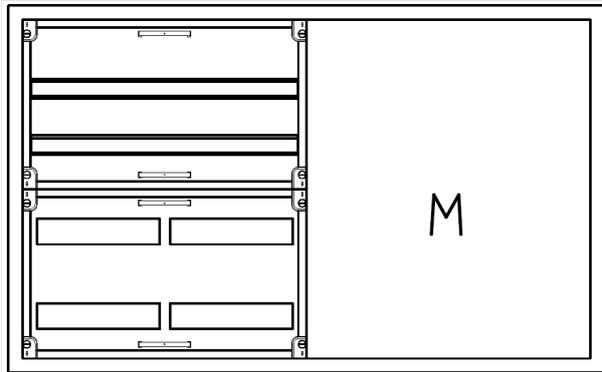
UVB4-4-210-M2 Automatenverteiler, UVB, BxHxT = 1050x650x210 Schutzklasse I, IP41, RAL 9016, Unterputz
