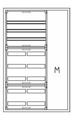
UVB3-8-210-M1-PAutomatenverteiler, UVB, BxHxT = 800x1250x210Schutzklasse I, IP41, RAL 9016, UnterputzBestehend aus:Gehäuse, Doppeltür mit Drehriegel, Flansche NF1 (oben) und NF2 (unten), 1x Geräteträger 2-Feld breit 3/5 mit Feldabdeckungen PS, 1x Montageplatte 1-Feld breit
