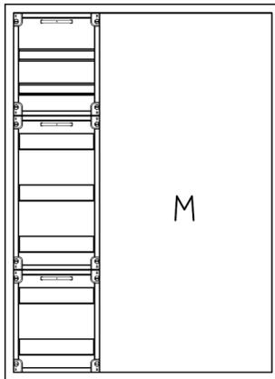
UVB3-7-210-M2 Automatenverteiler, UVB, BxHxT = 800x1100x210 Schutzklasse I, IP41, RAL 9016, Unterputz Bestehend aus: Gehäuse, Doppeltür mit Drehriegel, Flansche NF1 (oben) und NF2 (unten), 1x Geräteträger 1-Feld breit 2/5 mit Feldabdeckungen PRL, 1x Montageplatte 2-Feld breit
