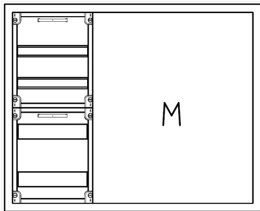
UVB3-4-210-M2 Automatenverteiler, UVB, BxHxT = 800x650x210 Schutzklasse I, IP41, RAL 9016, Unterputz Bestehend aus: Gehäuse, Doppeltür mit Drehriegel, Flansche NF1 (oben) und NF2 (unten), 1x Geräteträger 1-Feld breit 2/2 mit Feldabdeckungen PRL, 1x Montageplatte 2-Feld breit
