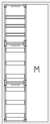
UVB2-9-210-M1-PAutomatenverteiler, UVB, BxHxT = 550x1400x210 Schutzklasse I, IP41, RAL 9016, Unterputz
