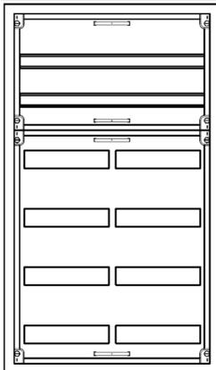
UVB2-6-210-PAutomatenverteiler, UVB, BxHxT = 550x950x210Schutzklasse I, IP41, RAL 9016, UnterputzBestehend aus:Gehäuse, Einzeltür mit Drehriegel, Flansche NF1 (oben) und NF2 (unten), 1x Geräteträger 2-Feld breit 2/4 mit Feldabdeckungen PS
