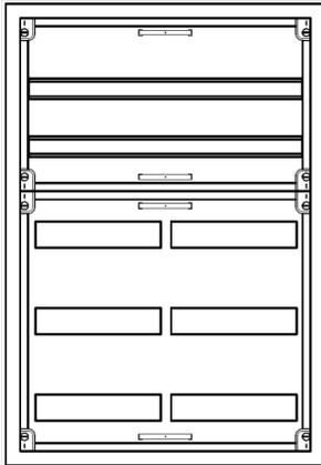
UVB2-5-210 Automatenverteiler, UVB, BxHxT = 550x800x210 Schutzklasse I, IP41, RAL 9016, Unterputz
