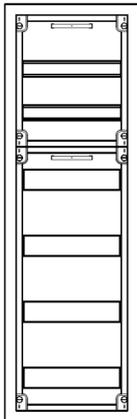
UVB1-6-210 Automatenverteiler, UVB, BxHxT = 300x950x210 Schutzklasse I, IP41, RAL 9016, Unterputz
