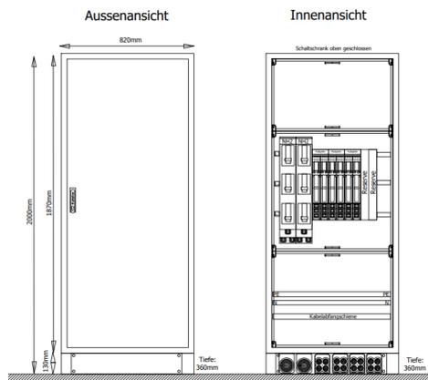
SVKNH2-6-3-12-360 M-Standverteilung, SVK, BxHxT = 820x1870+130x360 Schutzklasse II, IP54, RAL 7035 Bestehend aus: Gehäuse, Sockel, Einzeltür mit Schwenkhebel für PHZ, Flansche SF32 (oben) und 2x KFL2-240, 4x KFL2-4/35 (unten), komplettem Geräteträger mit Feldabdeckungen PRL, Wandhalterung best. mit
