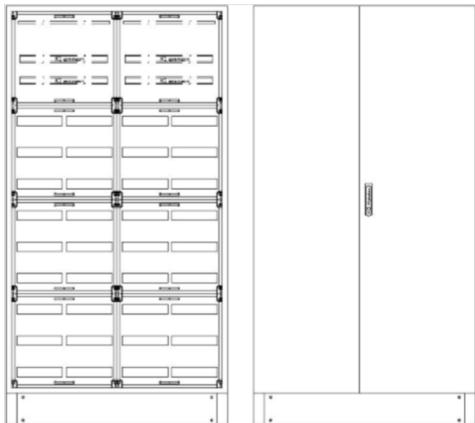
SVK4-12-230 Standverteilung, SVK, BxHxT = 1050x1850+150x230 Schutzklasse II, IP54, RAL 7035 Bestehend aus: Gehäuse, Sockel, Doppeltür mit Schwenkhebel für PHZ, Flansche SF45 (oben) und SF41 (unten), komplettem Geräteträger mit Feldabdeckungen PRL, Wandhalterung
