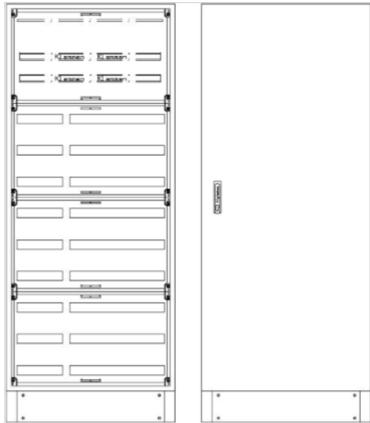
SVK3-12-360 Standverteilung, SVK, BxHxT = 820x1870+130x360 Schutzklasse II, IP54, RAL 7035 Bestehend aus: Gehäuse, Sockel, Einzeltür mit Schwenkhebel für PHZ, Flansche SF31 (oben) und SF32 (unten), komplettem Geräteträger mit Feldabdeckungen PRL, Wandhalterung
