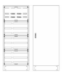
SVK3-12-230Standverteilung, SVK, BxHxT = 800x1850+150x230Schutzklasse II, IP54, RAL 7035Bestehend aus:Gehäuse, Sockel, Einzeltür mit Schwenkhebel für PHZ, Flansche SF45 (oben) und SF41 (unten), komplettem Geräteträger mit Feldabdeckungen PRL, Wandhalterung
