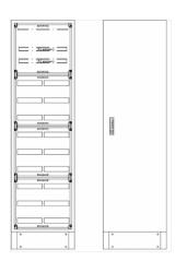
SVK2-12-400Standverteilung, SVK, BxHxT = 570x1870+130x400Schutzklasse II, IP54, RAL 7035Bestehend aus:Gehäuse, Sockel, Einzeltür mit Schwenkhebel für PHZ, Flansche SF31 (oben) und SF32 (unten), komplettem Geräteträger mit Feldabdeckungen PRL, Wandhalterung
