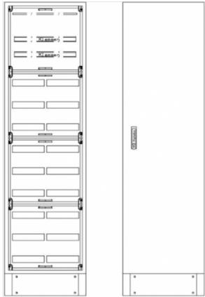
SVK2-12-230 Standverteilung, SVK, BxHxT = 550x1850+150x230 Schutzklasse II, IP54, RAL 7035 Bestehend aus: Gehäuse, Sockel, Einzeltür mit Schwenkhebel für PHZ, Flansche SF45 (oben) und SF41 (unten), komplettem Geräteträger mit Feldabdeckungen PRL, Wandhalterung
