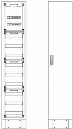
SVK1-12-210 Standverteilung, SVK, BxHxT = 300x1850+150x210 Schutzklasse II, IP41, RAL 7035 Bestehend aus: Gehäuse, Sockel, Einzeltür mit Schwenkhebel für PHZ, Flansche NF1, komplettem Geräteträger mit Feldabdeckungen PRL, Wandhalterung
