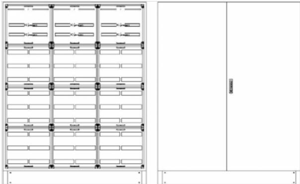
SVB6-12-360 Standverteilung, SVB, BxHxT = 1570x1870+130x360 Schutzklasse I, IP54, RAL 7035 Bestehend aus: Gehäuse, Sockel, Doppeltür mit Schwenkhebel für PHZ, Flansche SF31 (oben) und SF32 (unten), komplettem Geräteträger mit Feldabdeckungen PRL, Wandhalterung
