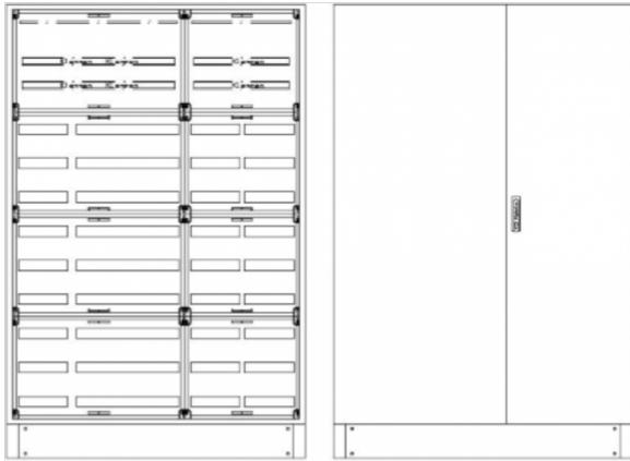
SVB5-12-500 Standverteilung, SVB, BxHxT = 1320x1870+130x500 Schutzklasse I, IP54, RAL 7035 Bestehend aus: Gehäuse, Sockel, Doppeltür mit Schwenkhebel für PHZ, Flansche SF31 (oben) und SF32 (unten), komplettem Geräteträger mit Feldabdeckungen PRL, Wandhalterung
