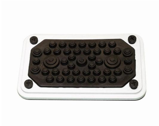
SF31 Flanschplatte SF31 Flansch mit Nippeleinsatz und Dichtungsgummi inkl. montierten Drehverschlusschrauben 42xPG 13,5; 5xPG 16; 2xPG 29 Einbauöffnung: 122x208 mm, IP41
