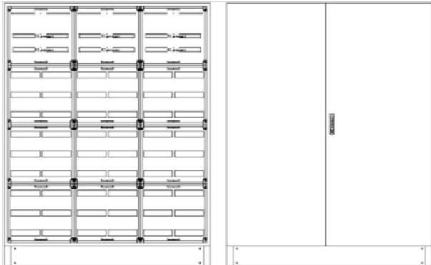
RSVK6-12-300Reihenschaltschrank, RSVK, BxHxT = 1570x1870+130x300Schutzklasse II, IP54, RAL 7035offene Seitenwände, Seitenwandprofil gekantet, für SchrankverbindungBestehend aus:Gehäuse, Sockel, Doppeltür mit Schwenkhebel für PHZ, Flansche SF35 (oben) und SF32 (unten), komplettem Geräteträger mit Feldabdeckungen PRL, Wandhalterung
