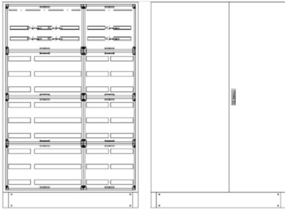
RSVK5-12-300Reihenschaltschrank, RSVK, BxHxT = 1320x1870+130x300Schutzklasse II, IP54, RAL 7035offene Seitenwände, Seitenwandprofil gekantet, für SchrankverbindungBestehend aus:Gehäuse, Sockel, Doppeltür mit Schwenkhebel für PHZ, Flansche SF35 (oben) und SF32 (unten), komplettem Geräteträger mit Feldabdeckungen PRL, Wandhalterung
