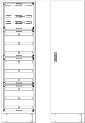
RSVK2-12-300Reihenschaltschrank, RSVK, BxHxT = 570x1870+130x300Schutzklasse II, IP54, RAL 7035, offene Seitenwände, Seitenwandprofil gekantet, für SchrankverbindungBestehend aus:Gehäuse, Sockel, Einzeltür mit Schwenkhebel für PHZ, Flansche SF35 (oben) und SF32 (unten), komplettem Geräteträger mit Feldabdeckungen PRL, Wandhalterung
