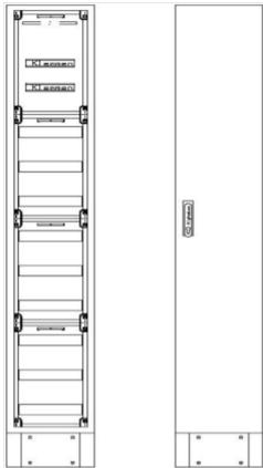
RSVK1-12-300Reihenschaltschrank, RSVK, BxHxT = 320x1870+130x300 Schutzklasse II, IP54, RAL 7035 offene Seitenwände, Seitenwandprofil gekantet, für Schrankverbindung Bestehend aus: Gehäuse, Sockel, Einzeltür mit Schwenkhebel für PHZ, Flansche SF35 (oben) und SF32 (unten), komplettem Geräteträger mit Feldabdeckungen PRL, Wandhalterung
