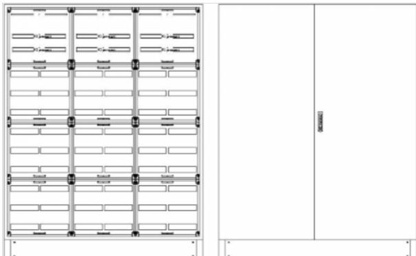
RSVB6-12-400Reihenschaltschrank, RSVB, BxHxT = 1570x1870+130x400Schutzklasse I, IP54, RAL 7035offene Seitenwände, Seitenwandprofil gekantet, für SchrankverbindungBestehend aus:Gehäuse, Sockel, Doppeltür mit Schwenkhebel für PHZ, Flansche SF31 (oben) und SF32 (unten), komplettem Geräteträger mit Feldabdeckungen PRL, Wandhalterung
