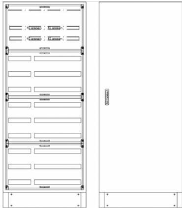
RSVB3-12-400Reihenschaltschrank, RSVB, BxHxT = 820x1870+130x400Schutzklasse I, IP54, RAL 7035offene Seitenwände, Seitenwandprofil gekantet, für SchrankverbindungBestehend aus:Gehäuse, Sockel, Einzeltür mit Schwenkhebel für PHZ, Flansche SF31 (oben) und SF32 (unten), komplettem Geräteträger mit Feldabdeckungen PRL, Wandhalterung
