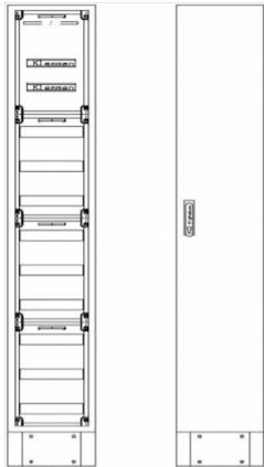
RSVB1-12-400Reihenschaltschrank, RSVB, BxHxT = 320x1870+130x400Schutzklasse I, IP54, RAL 7035offene Seitenwände, Seitenwandprofil gekantet, für SchrankverbindungBestehend aus:Gehäuse, Sockel, Einzeltür mit Schwenkhebel für PHZ, Flansche SF31 (oben) und SF32 (unten), komplettem Geräteträger mit Feldabdeckungen PRL, Wandhalterung
