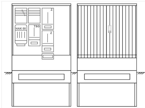
Zähleranschlussssäule für den Außenbereich mit Regendach,
