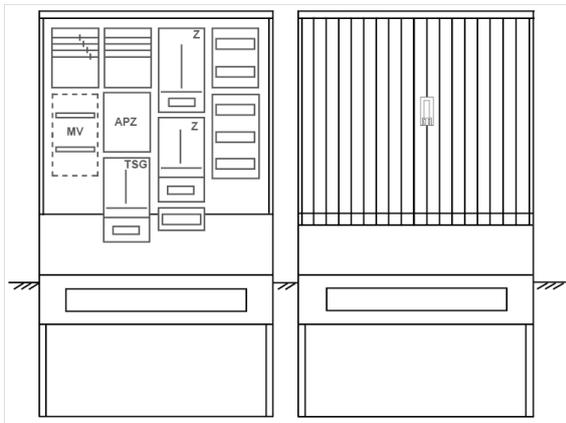
Zähleranschlussssäule für den Außenbereich mit Regendach,
