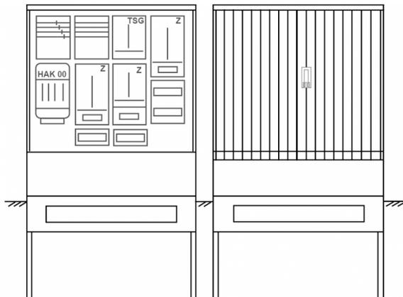
Zähleranschlussssäule für den Außenbereich mit Regendach,
