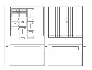
Zähleranschlusssäule für den Außenbereich mit Regendach,
