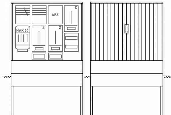
Zähleranschlussssäule für den Außenbereich mit Regendach,
